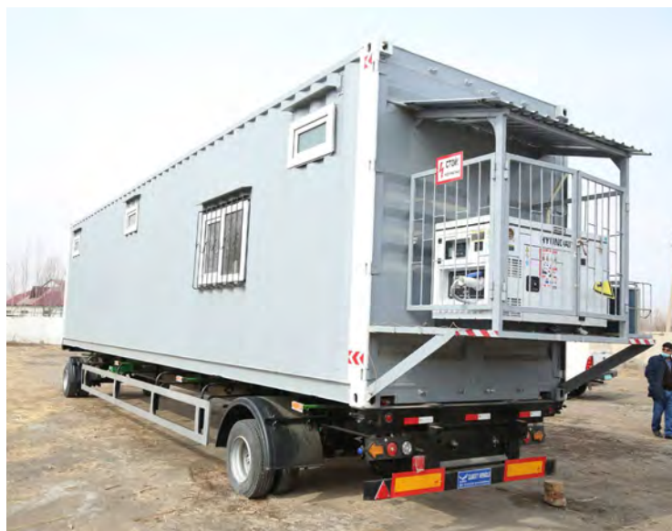
Фото 9. Мобильные вагон-дома для вахтовых бригад
